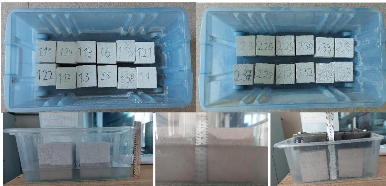
Рисунок. 4.36 – Насыщение водой газобетонных образцов
