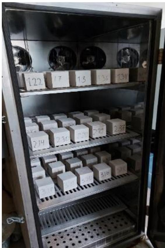
Рисунок 4.38 – Определение морозостойкости кубов из автоклавного газобетона в морозильной камере
