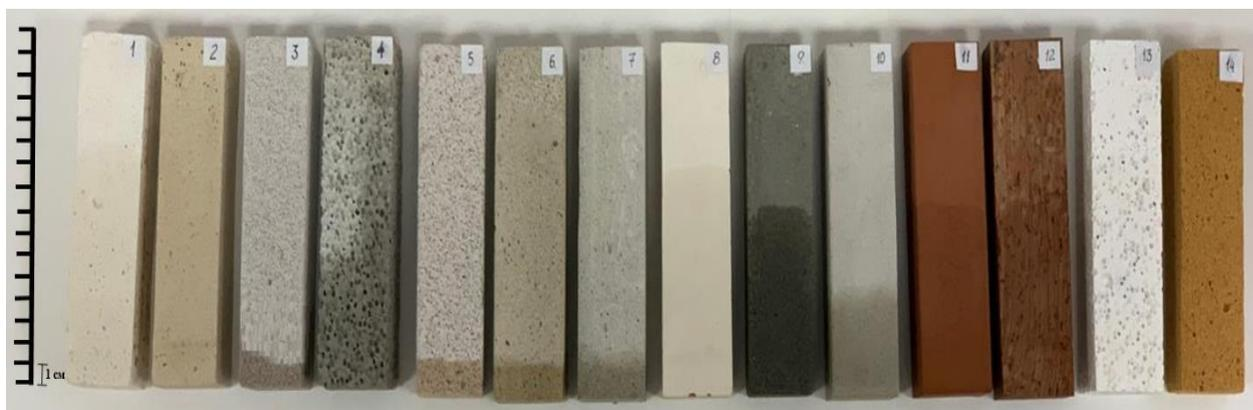
Рисунок 4.34 – Уровень водопоглощения образцов по истечению 90 мин с начала эксперимента
