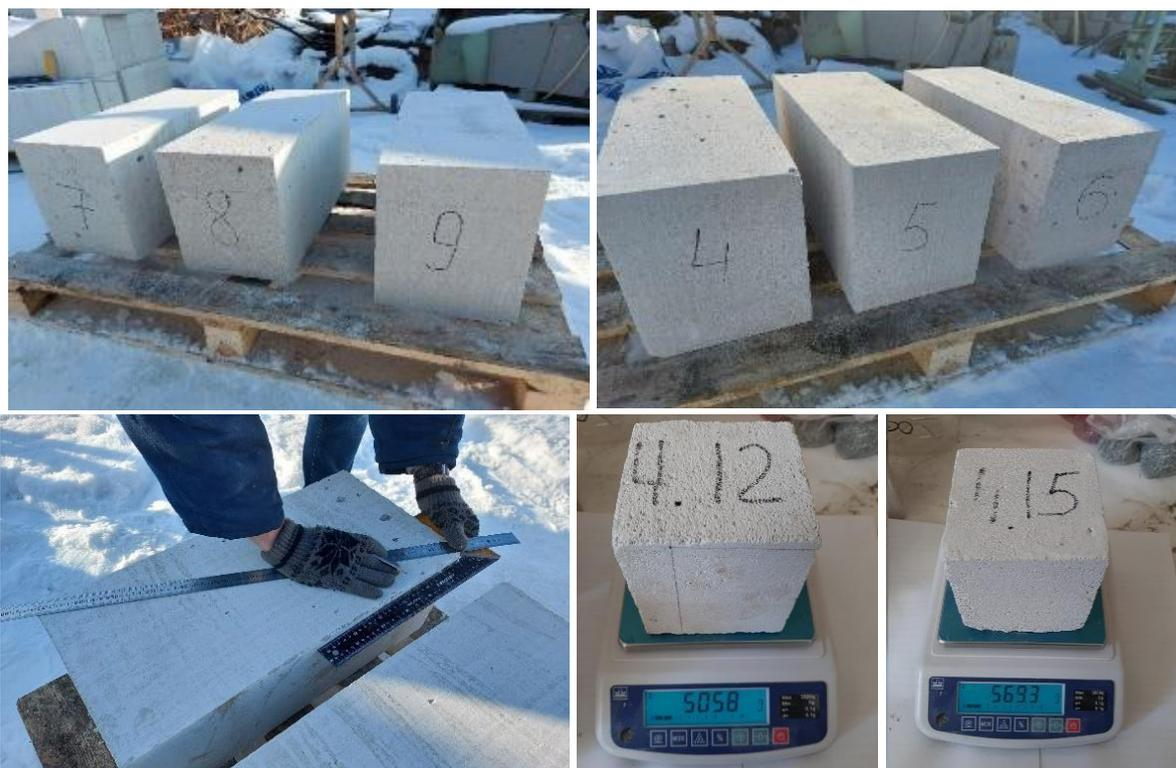
Рис. 4.21 – Подготовка образцов для испытаний из газобетонных блоков ЗАО «Могилевский КСИ» (г. Могилев, Республика Беларусь)
