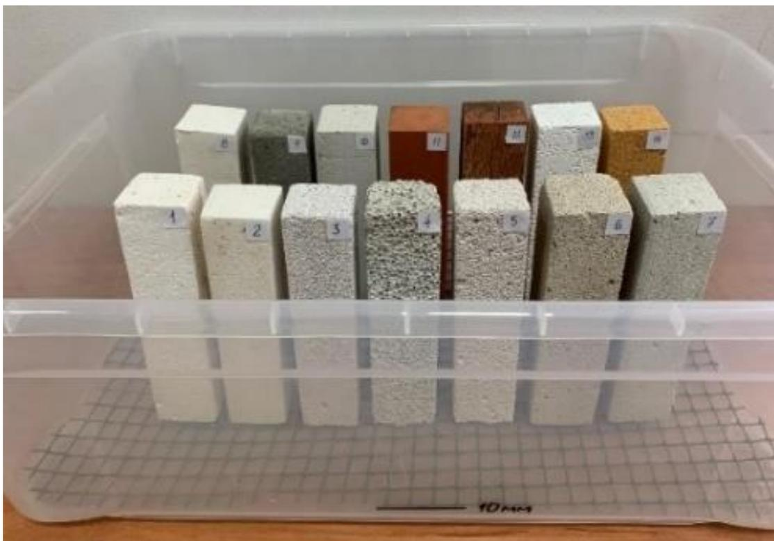
Рисунок 4.32 – Образцы в начале испытания по определению капиллярного водопоглощения
