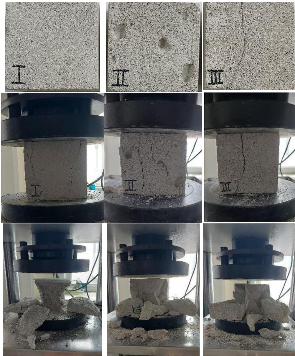
Рисунок 4.16 – Испытание образцов газобетона: I – с высокоорганизованной структурой, II – с крупными порами воздухововлечения, III – с разрывом сплошности
