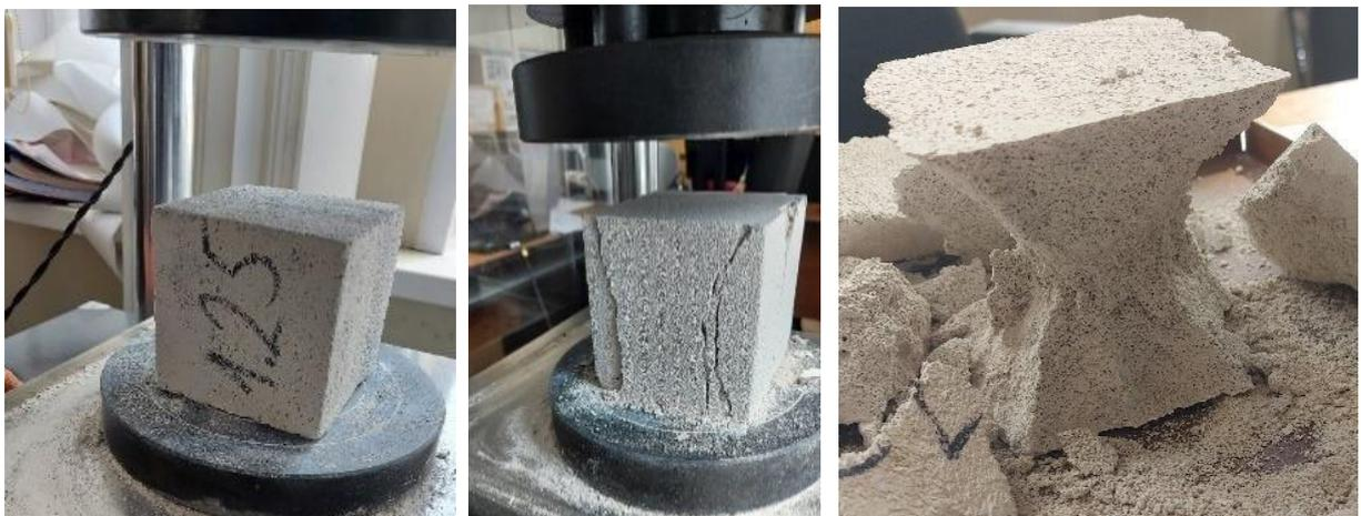
Рисунок 4.22 – Определение прочности при сжатии кубов из автоклавного газобетона D500 (производитель ООО «Масикс» (г. Ростов-на-Дону, Россия))
