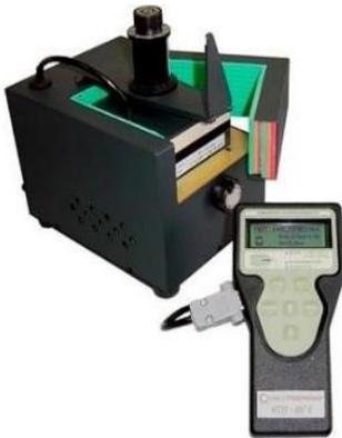
Рисунок 2.4 – Прибор для измерения теплопроводности ИТП-МГ4 «100»
