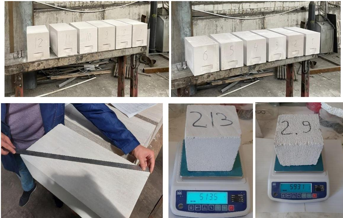
Рис. 4.19 – Подготовка образцов для испытаний из газобетонных блоков ООО «ЛСР. Стеновые» (п. Кикерино, Ленинградская обл., Россия)
