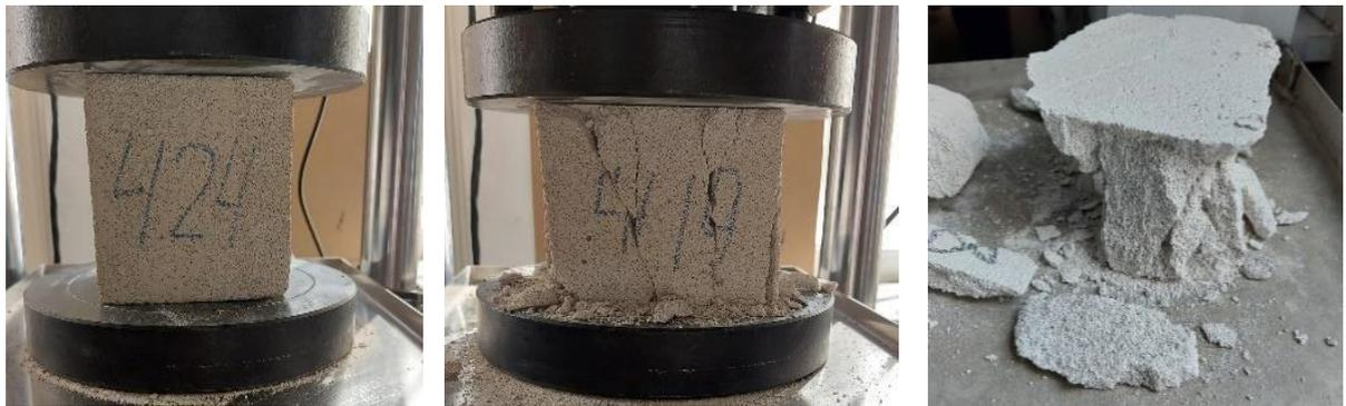
Рисунок 4.25 – Определение прочности при сжатии кубов из автоклавного газобетона D500 (производитель ЗАО «Могилевский КСИ» (г. Могилев, Республика Беларусь)
