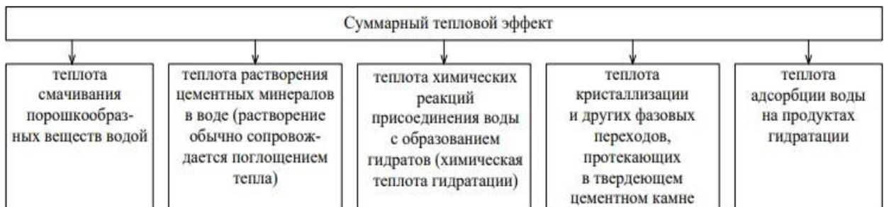
Рисунок 1.6 – Суммарный тепловой эффект при реакции гидратации цемента
