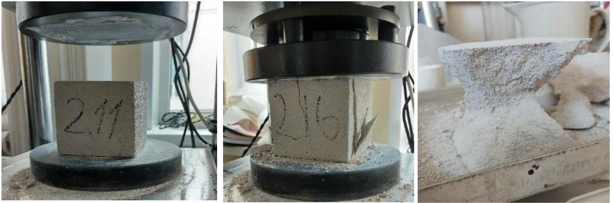
Рисунок 4.23 – Определение прочности при сжатии кубов из автоклавного газобетона D500 (производитель ООО «ЛСР. Стеновые» (п. Кикерино, Ленинградская обл., Россия)
