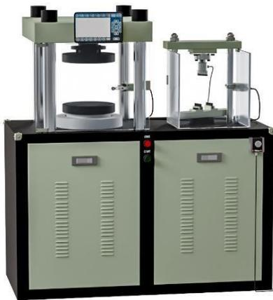
Рисунок 2.3 – Общий вид машин МИФ – 600.1.2.С
