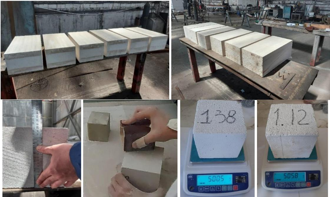
Рисунок 4.18 – Подготовка образцов для испытаний из газобетонных блоков ООО «Масикс» (г. Ростов-на-Дону, Россия), изготовленных по модернизированной технологии
