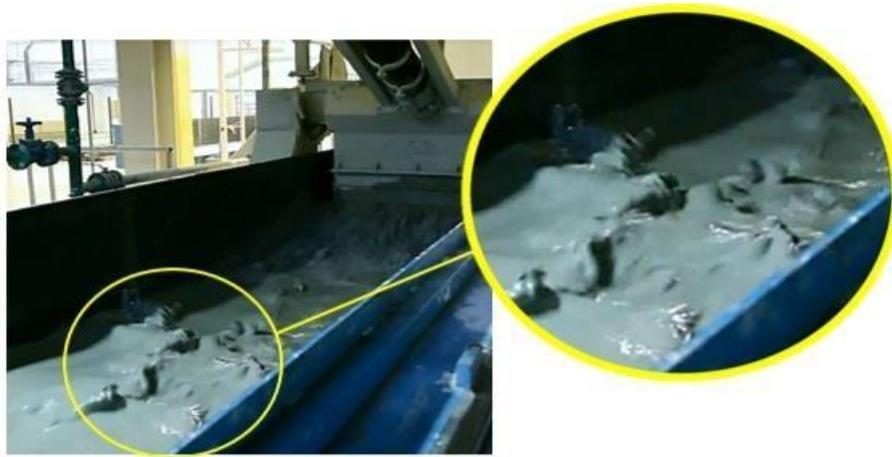
Рисунок 4.13 – Турбулентность смеси
