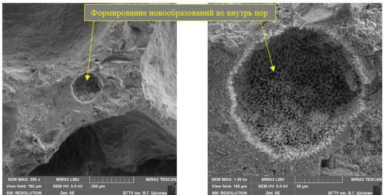
Рисунок 3.15 – Мембранная пористость газобетона *D500*
