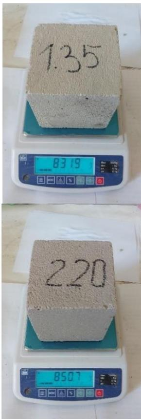
Рисунок 4.37 – Определение массы газобетонных образцов
