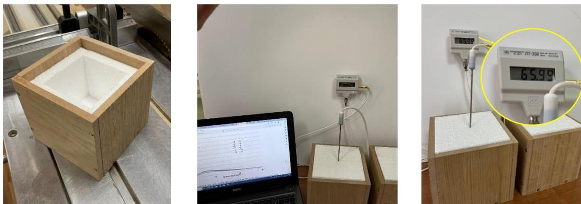
Рисунок 2.2 – Формы для определения тепловыделения в газобетонных массивах
