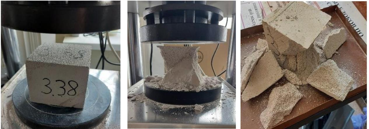
Рисунок 4.24 – Определение прочности при сжатии кубов из автоклавного газобетона D500 (производитель ЗАО «Аэробел» (г. Белгород, Россия)
